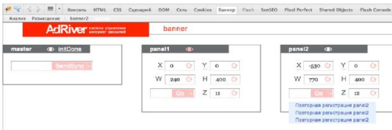
Второй из баннеров (вкладка *banner*) распознается приложением как баннер MPU, однако во второй панели имеется три одинаковых сообщения об ошибке – «Повторная регистрация panel2». Очевидно наличие ошибки в коде ролика панели 2, вызывающей закливание функции registerPanel.
